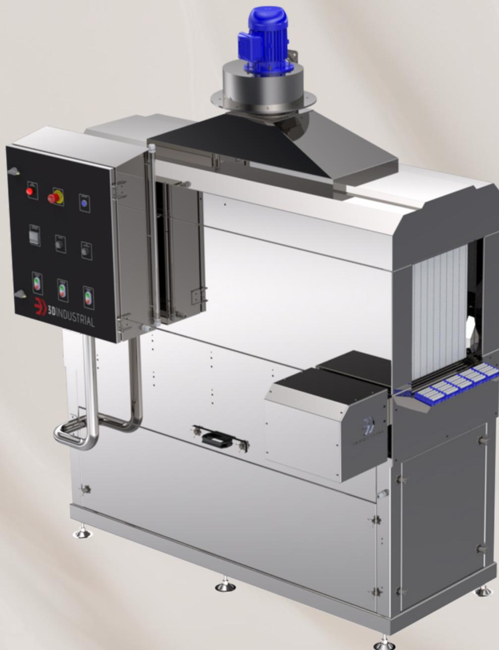
Desenvolvido para realizar o encolhimento de embalagens plásticas com cascata de água aquecida por vapor ou resistência elétrica garantindo uma eficiência para a produção;
