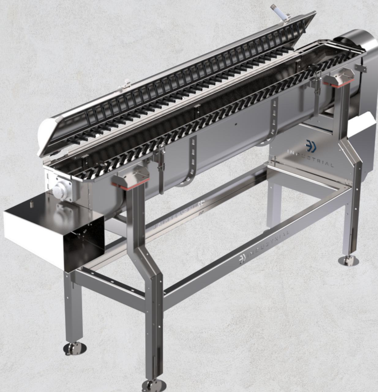
Equipamento desenvolvido para depilar patas usando dedos de borracha;
